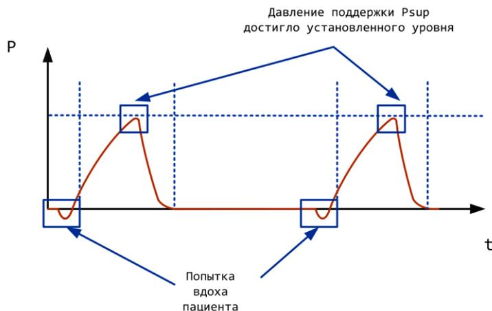
Рисунок 7 – Условия срабатывания триггера выдоха в режиме PSV
