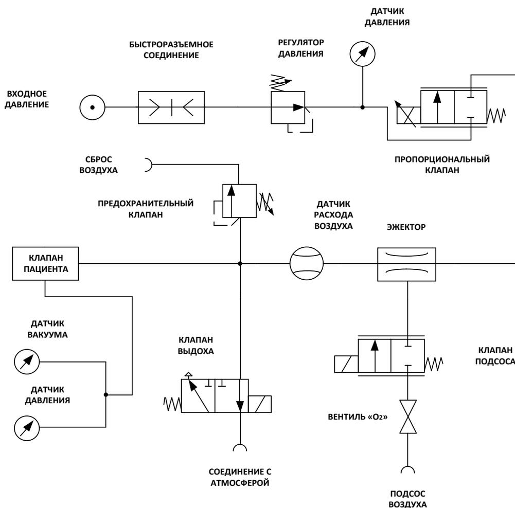
На вход подается давление от 270 до 660 кПа (2,7-6 бар), которое регулятором давления понижается до 270 кПа (2,7 бар) и подается на пропорциональный клапан.
